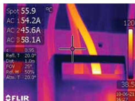
L'ispezione rileva l'esistenza di anomalie nella zona dei cavi vicini ai fusibili protetti da plexiglas. Grazie a MeterLink, i valori letti dalla pinza amperometrica vengono visualizzati sull'immagine termografica.
